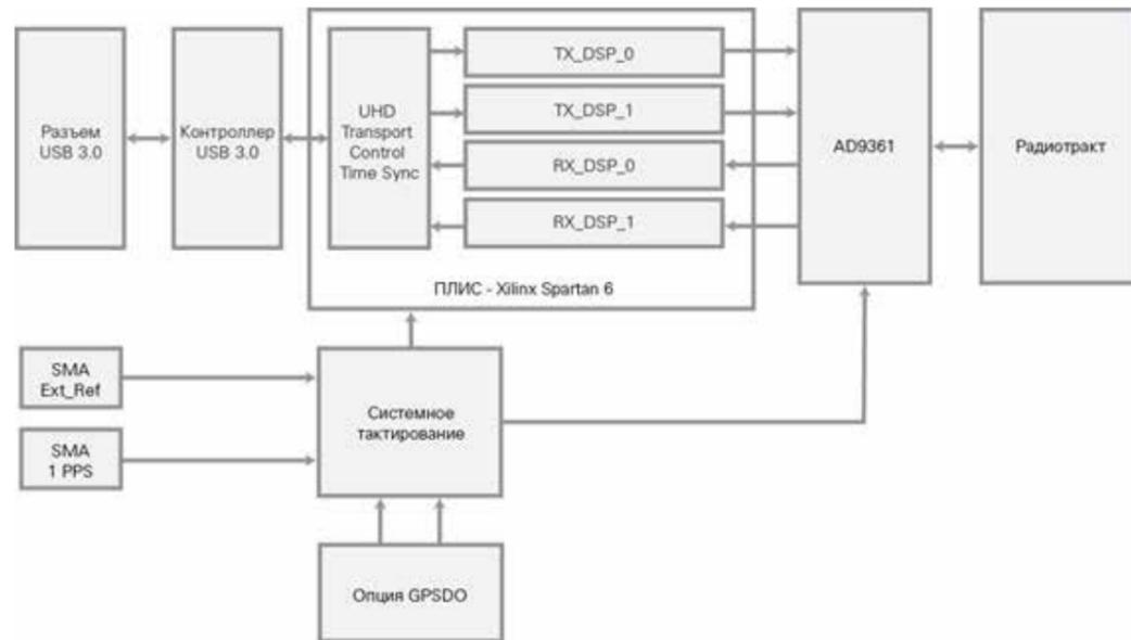
Устройства серии B200mini выполнены на единой плате, где объединены радиотракт, интегрированная микросхема приемопередатчика AD9364, ПЛИС, интерфейс USB 3.0, а также система синхронизации.
